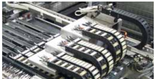
Versuch CF98.05.04 im Radius 18 mm: 69,3 Mio. Doppelhübe test of CF98.05.04 with 18 mm radius: 69.3 million double strokes
