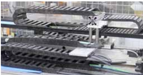
CFLG.2LB.50/125 getestet mit 70,4 Mio. Hübren bei 4,35 x d CFLG.2LB.50/125 tested with 70.4 million strokes at 4.35 x d
